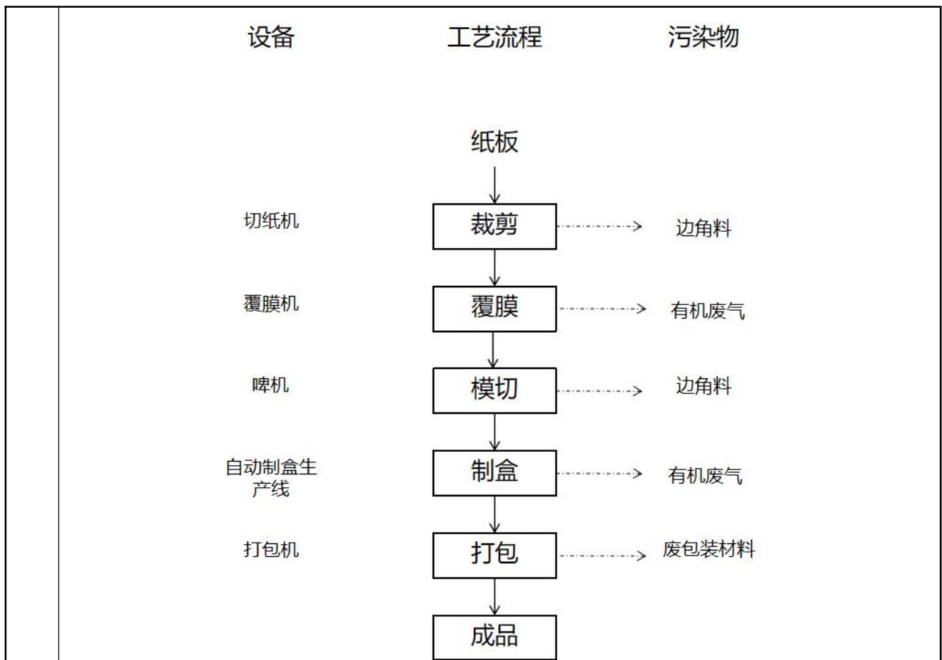
图 2-3 彩盒生产工艺流程及产污环节图
